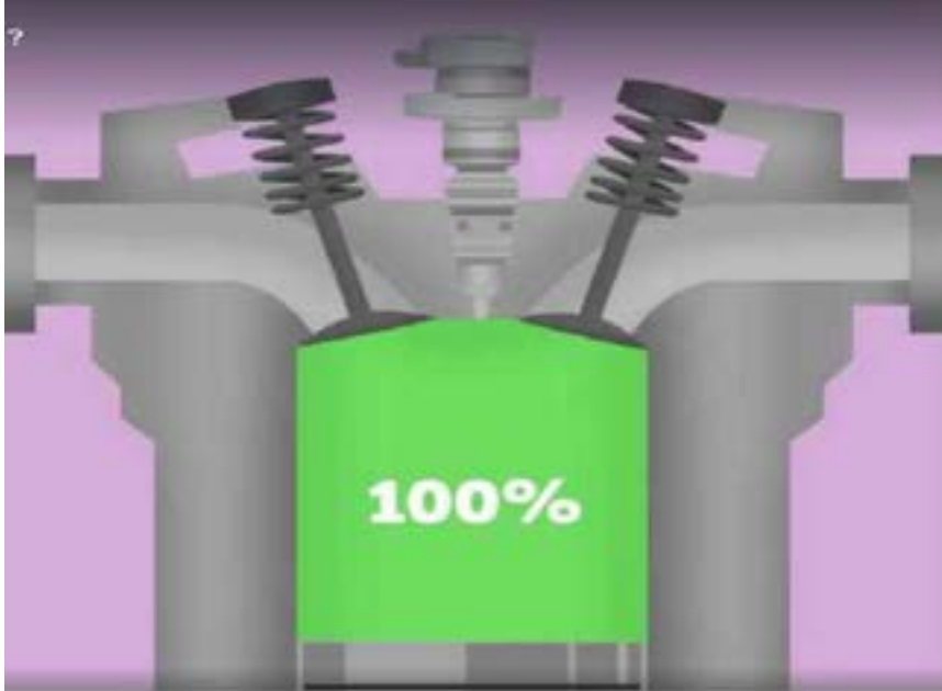
Actual vol. available ( V_s ) inside a cylinder
